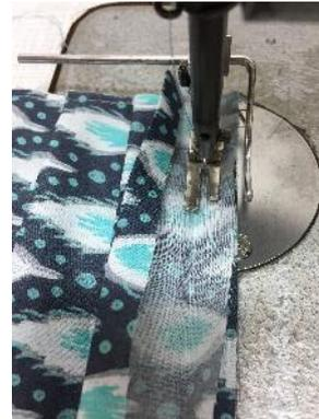
5 Dreht die Maske um und legt euren Einfass schön umgeklappt auf rechts, so dass die erste Naht verdeckt wird. Schiebt Euren Draht in den entstandenen Tunnel und steppt den Streifen fest. Ebenso verfährt Ihr auf der gegenüberliegenden Seite - nur ohne Draht.
